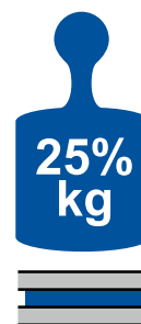
Montaż poziomy = 25 % podanej nośności
